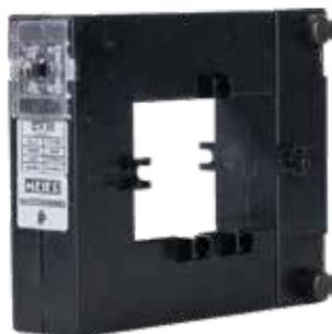
La série **CTK58** est un transformateur de courant à noyau ouvrant, assemblé par des vis et écrous. Il convient aux courants primaires de **250A à 1600A AC**. Disponible dans les classes de précision **3, 1 ou 0,5**.
