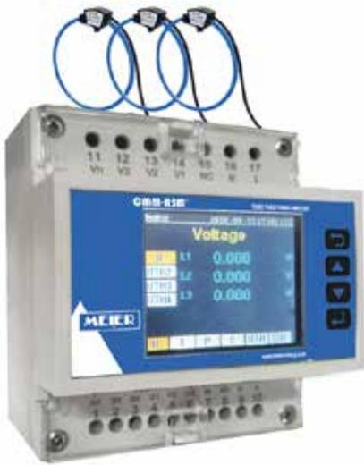
La centrale de mesure **CMM-R5M** permet de mesurer les principaux paramètres électriques du réseau et d'assurer le comptage bidirectionnel de l'énergie. Elle est dotée de 4 entrées de mesure de tension et de 3 entrées de mesure de courant pour capteurs flexibles (tores de Rogowski).
